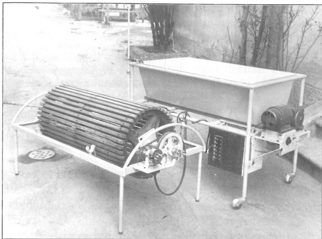
Fig. 2 - Il rene artificiale costruito dalla ditta Giuseppe Cavallo nel 1947 su commissione di Fieschi con il cilindro di legno e la vasca per il liquido di dialisi (dall'archivio della Ditta Cavallo, Buccinasco, Milano).
